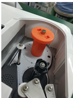
(1) 打开防尘盖并将纸限位块取下
