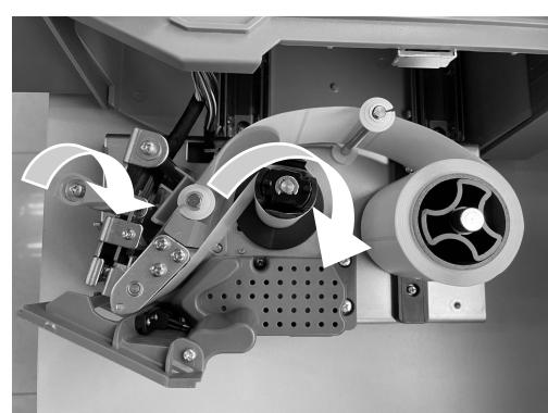
(5) 将纸卷前端绕过过滤板卷入收纸轴，合上打印头（如上图示）
