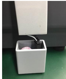
2. 将接好的空中接头塞进显示杆内部
